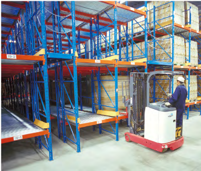
パレットフローラック ■ 先入れ先出し方式の流動棚。パレット品の高密度保管に。
